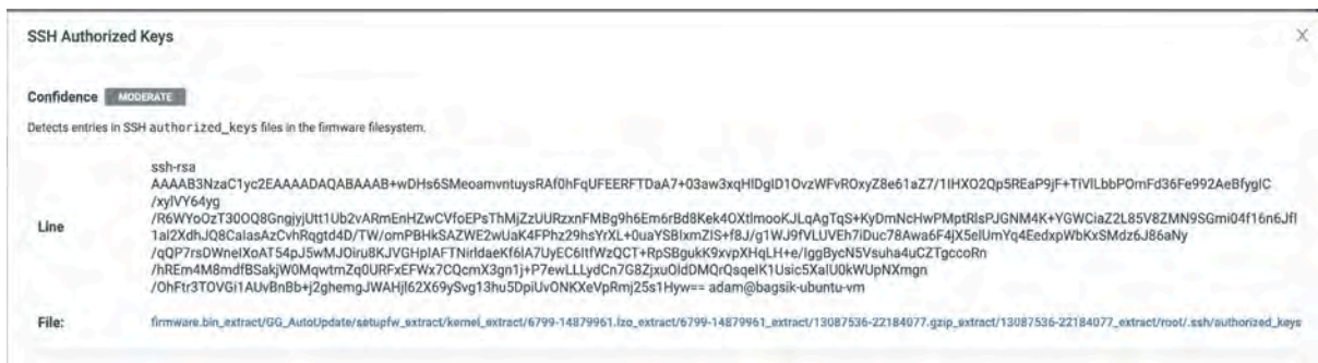
Abbildung 72: In der Firmware gefundener öffentlicher SSH-Schlüssel
