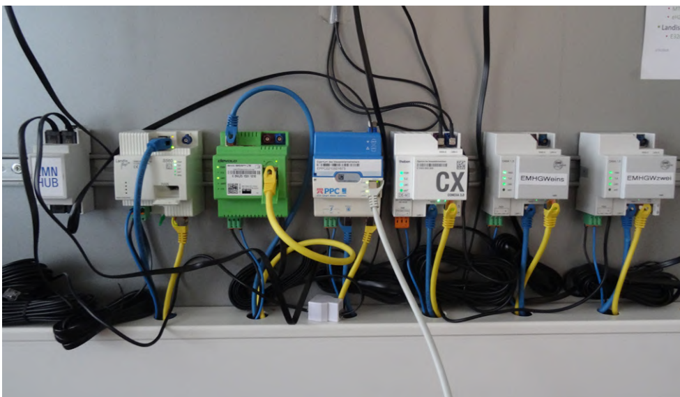
Abbildung 45: Teststand zur Prüfung und Integration verschiedener Smart Meter Gateways als Schnittstelle zum Energiemanagementsystem im House of Living Labs.
