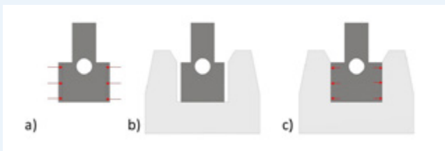
Bild 1: Umform- und Aktivierungsprozess mit a) Stauchen, b) Einsetzen, c) Aktivieren und Erzeugen der Klemmkraft, © PohlCon GmbH
