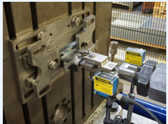
Bild 2: Auszugsversuche unter Laborbedingungen, © PohlCon GmbH
