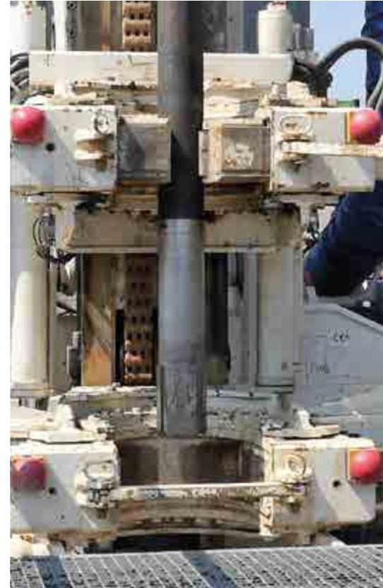
LaserJetDrilling Prototyp eingebaut in Bohrgerät
