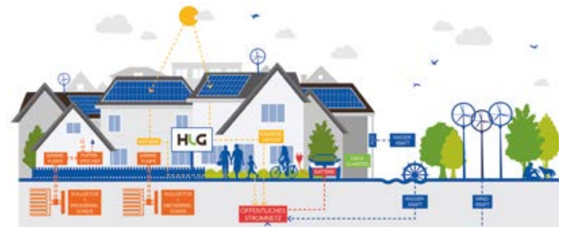
Elemente der Plusenergie-Siedlung: Energieeffizienz, erneuerbare Energieerzeugung, Speichersysteme (Quelle: HLG)
